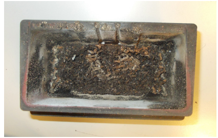
BEISPIEL VERSCHMUTZTE BRENNSCHALE
