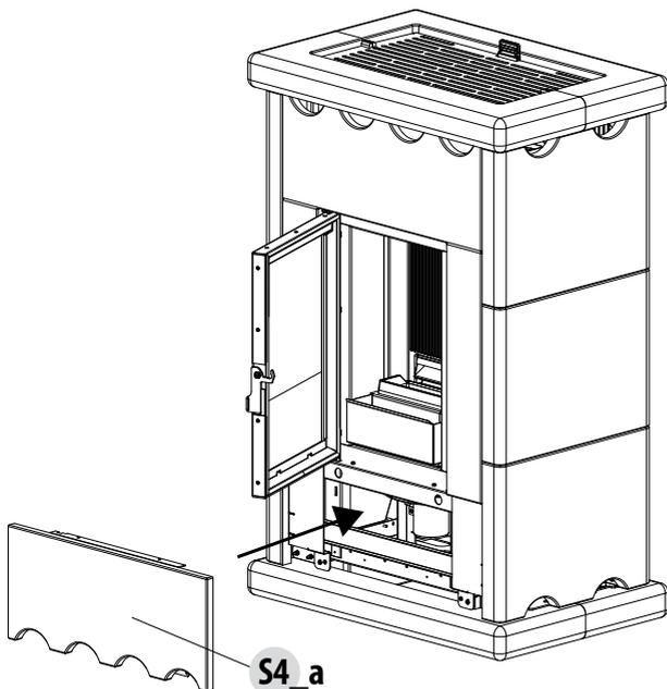
Pour accéder au ventilateur, il est nécessaire d'enlever le panneau en pierre sous la porte. Pour la procédure de retrait de la plaque inférieure, voir le chapitre spécifique dans la section 6 de ce manuel.
