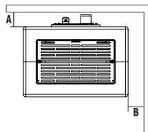
Si le sol est constitué d'un matériau combustible, il est conseillé d'utiliser une protection en matériau incombustible (acier, verre...) qui protège aussi la partie frontale de la chute éventuelle des produits brûlés durant les opérations de nettoyage.
