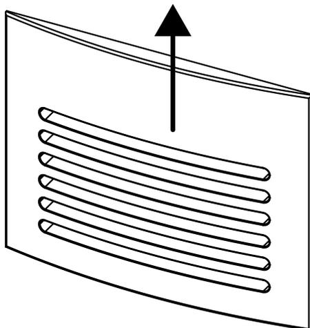
Les écrous sous la porte de chargement ne sont pas fermés pour permettre d'introduire facilement le panneau S3 ; par conséquent, après avoir placé le panneau S3, soulever la porte et, sous les entretoises du couvercle, bien fermer les deux écrous de manière à bloquer définitivement le panneau.
