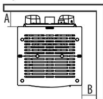
Si le sol est constitué d'un matériau combustible, il est conseillé d'utiliser une protection en matériau incombustible (acier, verre...) qui protège aussi la partie frontale de la chute éventuelle des produits brûlés durant les opérations de nettoyage.
