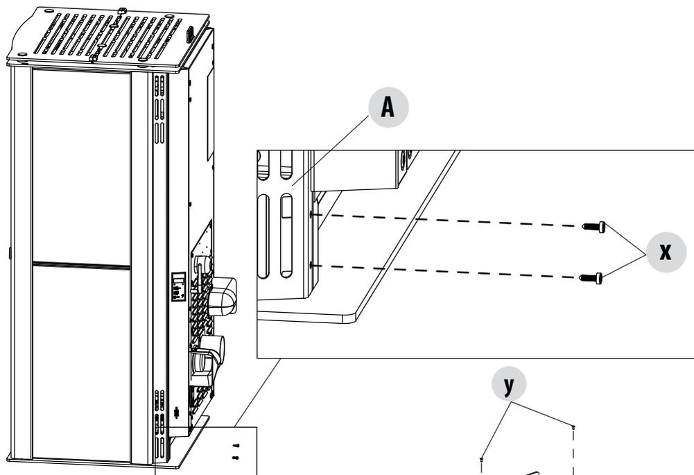
Fixer le profil « A » à l'arrière au moyen des deux vis « x », tandis que dans la partie supérieure, lever la porte du réservoir et fixer les deux vis « y ».
