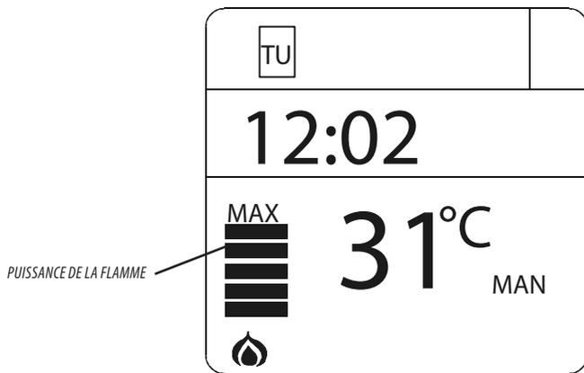
En cas de configuration MANUELLE de la ventilation, la fonction qui limite la puissance maximale du poêle en fonction de la ventilation, est activée.
