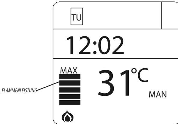
Ist die Belüftung auf die Betriebsart MANUELL eingestellt, so wird eine Funktion aktiviert, die die maximale Leistung des Ofens auf Grundlage der Belüftung begrenzt.
