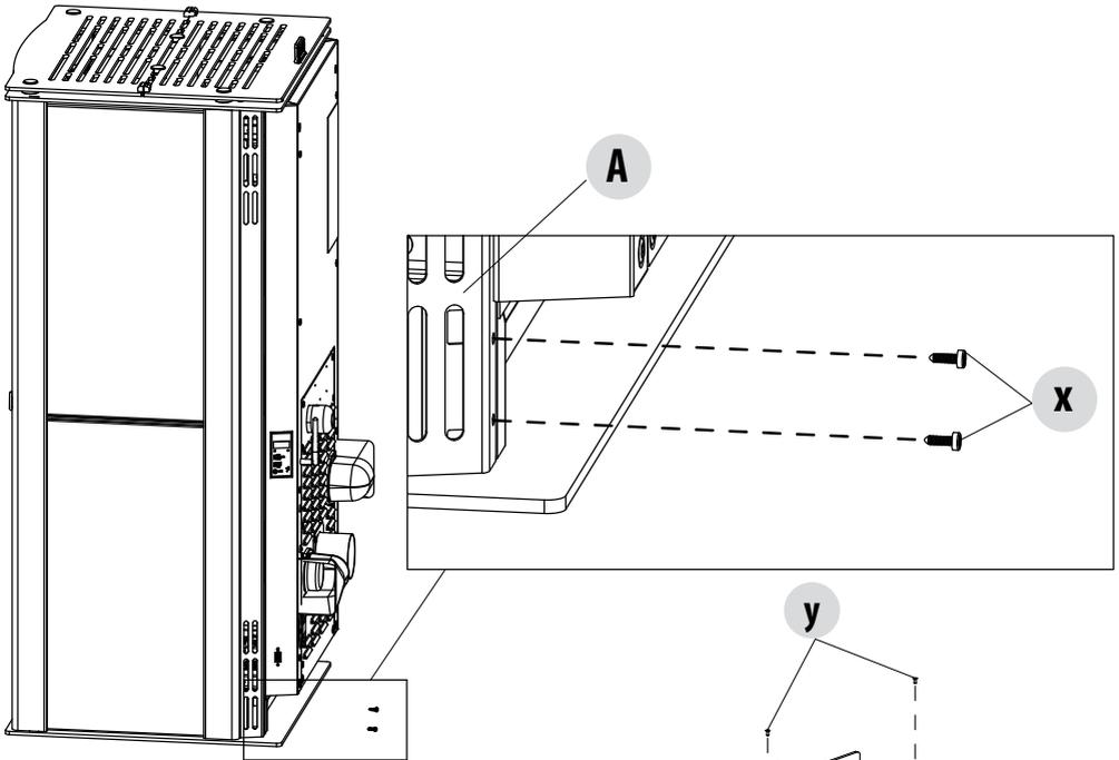
Das Profil "A" mit den beiden Schrauben "x" wieder am hinteren Teil befestigen, während die Klappe des Behälters im oberen Teil anzuheben und die beiden Schrauben "y" zu befestigen sind.
