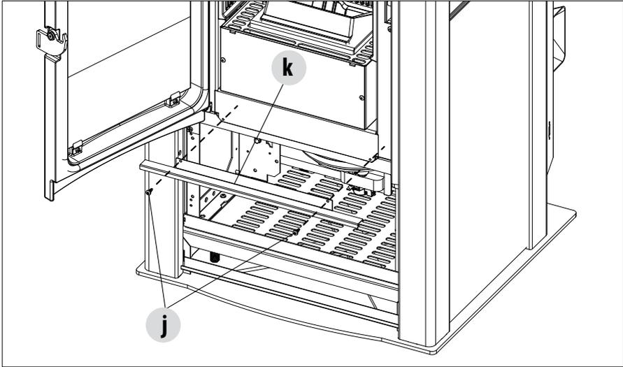
Nach der Einfügung des Steins "S2" in den unteren Teil ist die Platte "S2" an den Ofen heranzuführen und der Bügel "k", der die Platte "S2" blockiert, wieder zu montieren.
